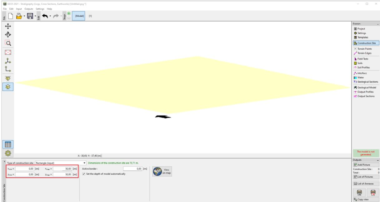
Vamos inserir uma sondagem onde podemos criar as três camadas de solo de acordo com o definido para a tarefa. É necessário definir a profundidade inicial da sondagem:  $z = 0$  m.
