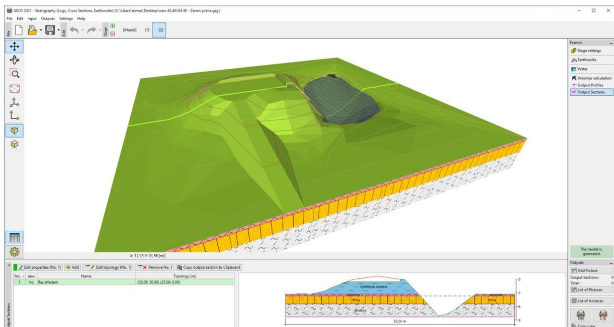
Na janela “Local de construção” vamos inserir as dimensões do modelo. Assumimos uma forma quadrada com 50 m de largura. As coordenadas x e y mínimas serão 0 m e as máximas 50 m.
