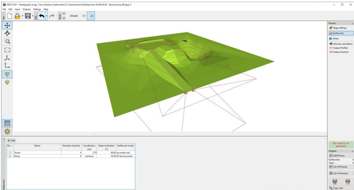
Vamos passar à janela “Massa de Água” e inserir a altura do nível de água do lago (z = -0.4 m). O nível de água está representado apenas por um ponto, em uma localização qualquer do modelo. O nível de água criado é horizontal.
