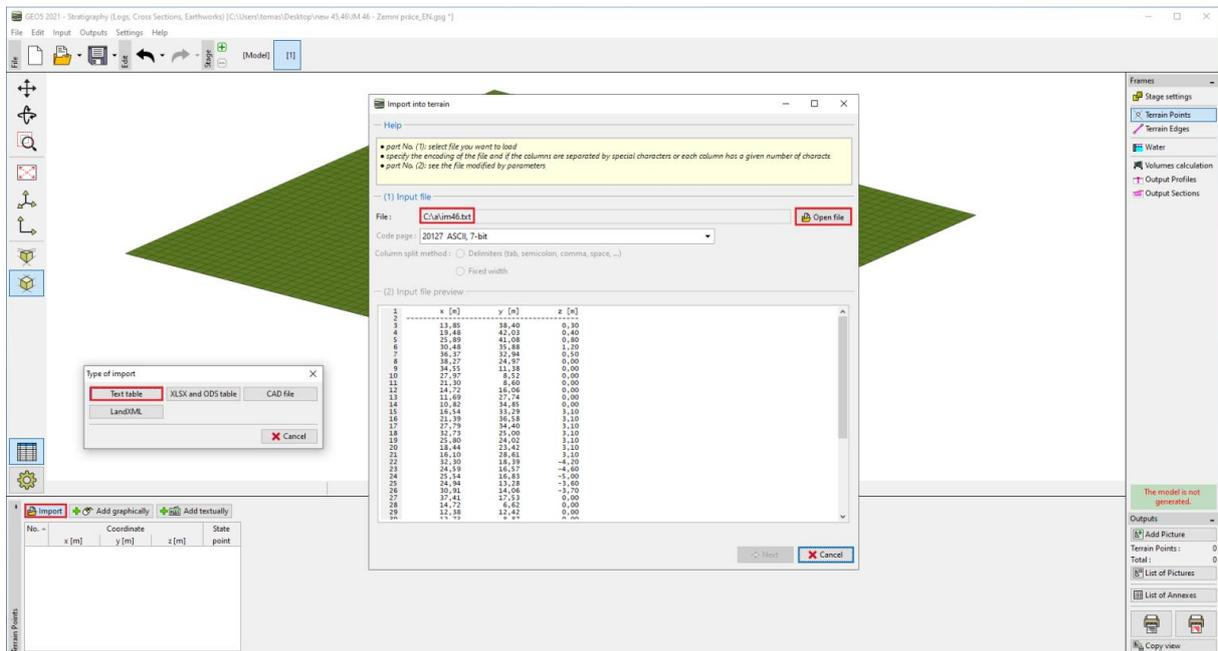
Após carregamento, a nova forma do terreno será gerada automaticamente.
