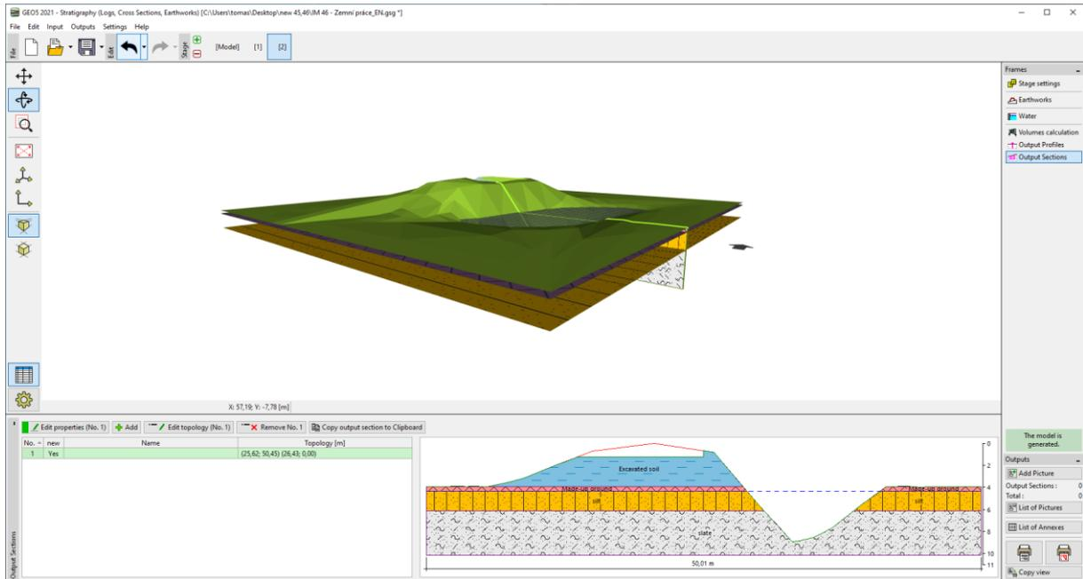
Depois, passamos ao programa “Estabilidade de Taludes” (barra de ferramentas superior: “Editar”; “Colar dados”) onde vamos inserir a secção. Após introduzir os parâmetros dos solos, sobrecargas e parâmetros de análise, podemos realizar a análise da construção.
