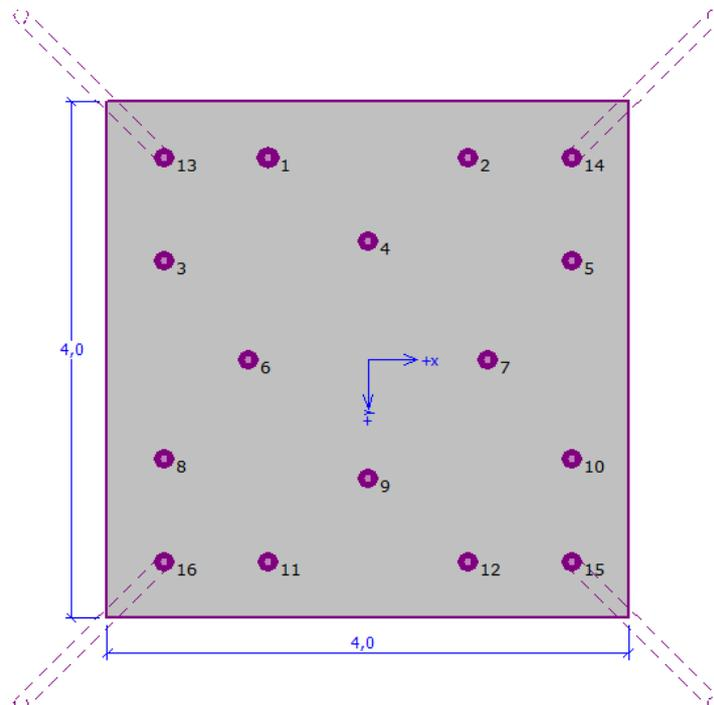
Imagem 1 – Esboço da fundação em microestacas
